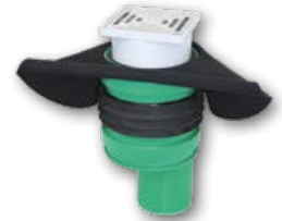
Odpyw podłogowy KRASO® typ FS - RS z kołnierzem foliowym, mrozoodporny - zabezpieczający przed cofaniem się wody
