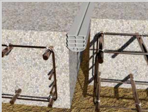
Taśmy do montażu mechanicznego / clamped waterstops
